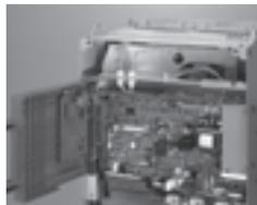
インバータ前面より、取り付けねじおよび電源コネクタを取りはずします。
