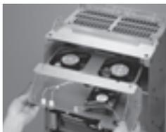
インバータの前面よりスライドさせながら冷却ファンのカートリッジを交換します。
