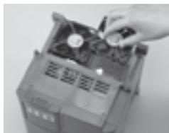
電源コネクタを取りはずし、冷却ファンを交換します。
