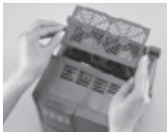
インバータ上部のカバーをワンタッチで取りはずします。
